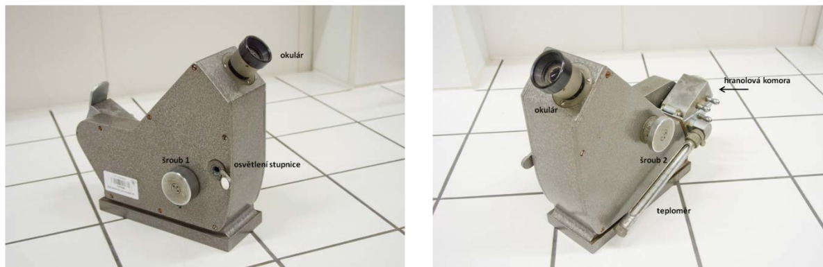
Obrázek 1-11: Univerzální refraktometr RL
