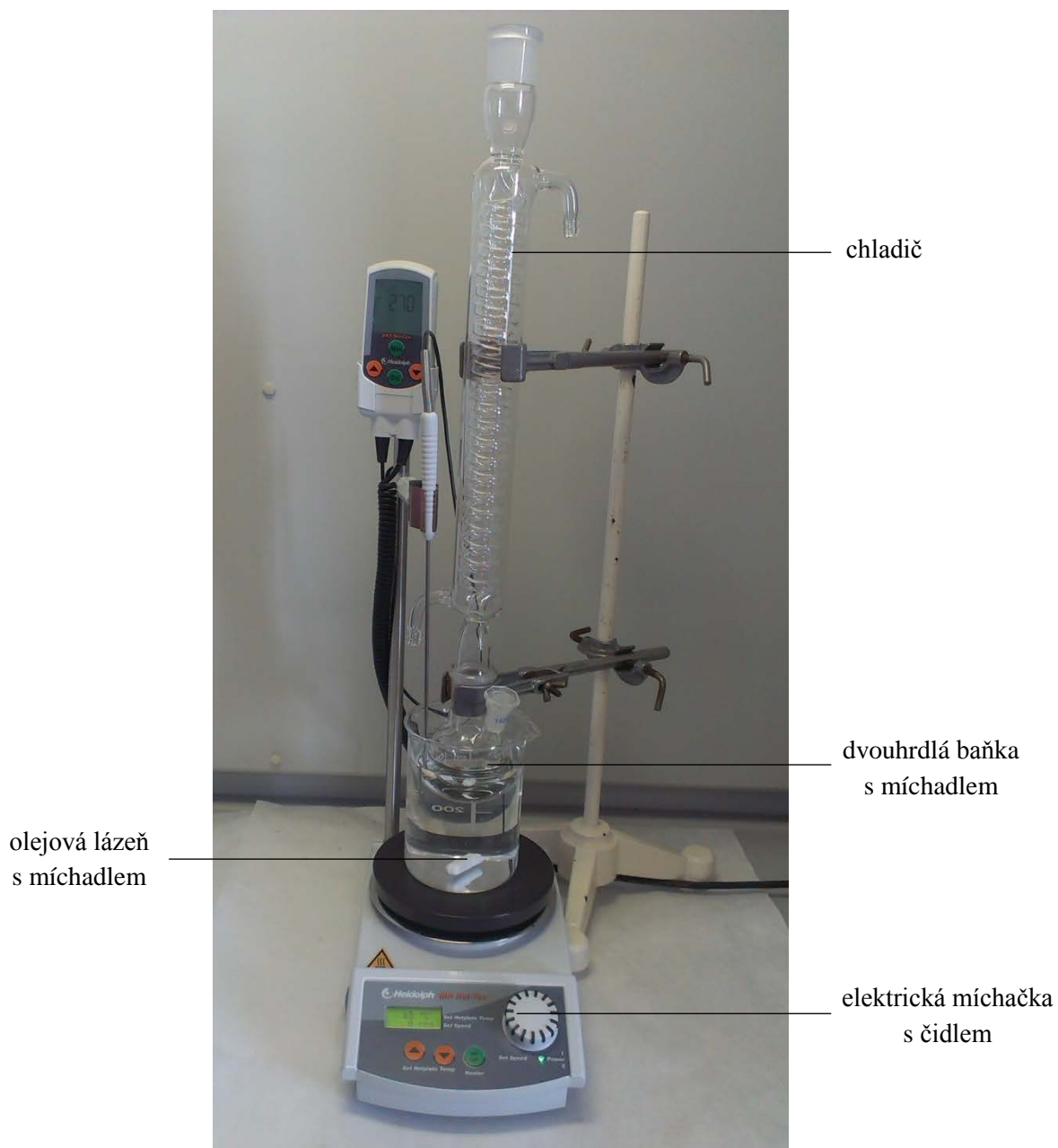
Obrázek 13-2: Schéma aparatury pro přípravu nanočástic stříbra
