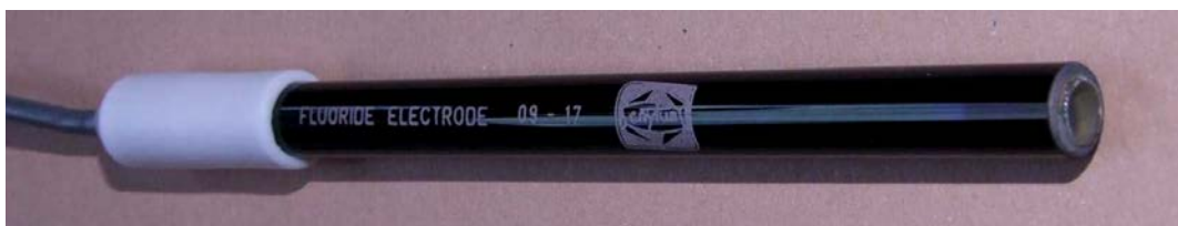
Obrázek 9-1: Fluoridová iontově selektivní elektroda (Monokrystaly, Turnov)
